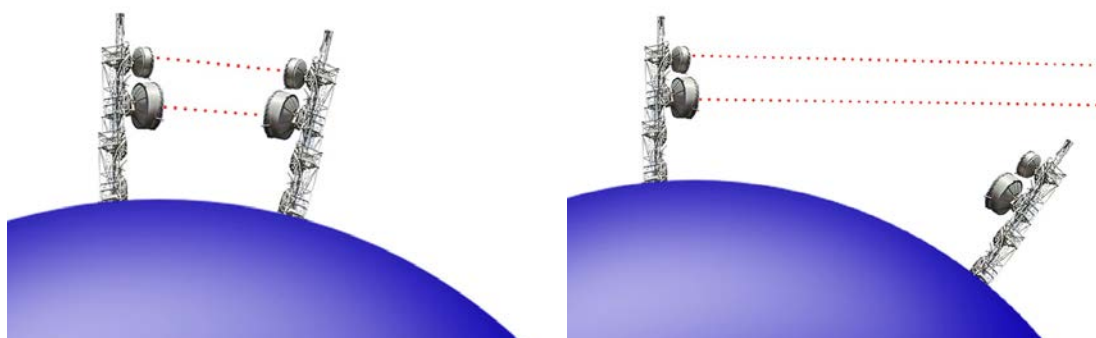
Antenas de microondas muito distantes não se comunicam devido à curvatura da Terra
